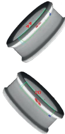
Fehler in der Mitte der äußeren Oberfläche in einer Außenansicht
